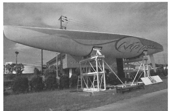
写真2 蒲郡に展示されているアメリカズカップ用ヨット。大きなセンターキールが取り付けられている。
