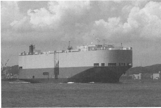
写真1 横風による斜航によって抵抗増加を起こしやすい自動車運搬船(PCC)
